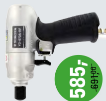
YD-670A-R Bithouder 1/4" 6K Schroefcapaciteit 6 mm Toerental 7.500 rpm Koppel 90 Nm Luchtverbruik 6,1 l/s Gewicht 0,98 kg
