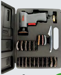
RRS-60152K MET ROLLOC™ SYSTEEM Schuurschijf 50 mm Toerental 15.000 rpm Vermogen 0,3 kW Luchtverbruik 4,9 l/s Gewicht 0,54 kg
